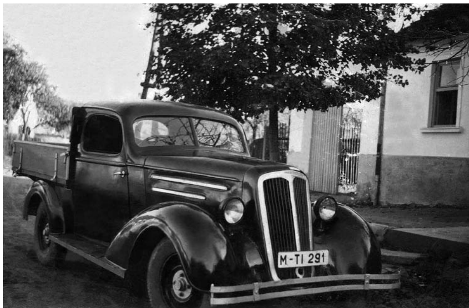
Obr. 1: Praga Alfa s valníkovou nástavbou a karosérií Chevrolet
